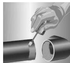
APPLICATION du polymère de soudure
