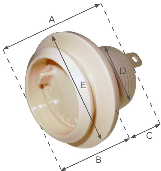
Les bouchons B ETUY sont en matière plastique et se présentent sous forme d'un tube possédant une membrane intérieure désoperculable. La partie à emboîter dans la conduite PVC est munie de 2 fanons permettant éventuellement de fixer un filin de pré-aiguillage. Suivant les différents types de bouchons, l'opercule possède de 1 à 3 points d'arrachage à utiliser lors de l'ouverture de la conduite.
