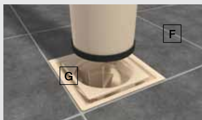
Positionner la grille de tube de descente (G) sur l'avaloir. Positionner la bague becquet (F) en partie basse du tube de descente.
