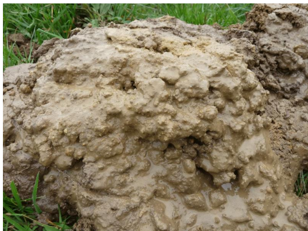
FIGURE N°14 : BOUES EXTRAITES D'UN LIT DE POSE AVANT MISE EN ŒUVRE DU BATIFIBRE SN4
