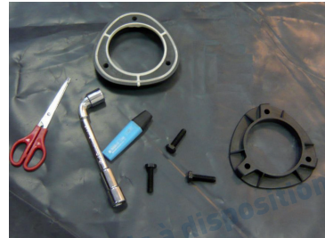
1. Outils nécessaires au montage de la traversée. (Ciseaux ou cutter, marqueur et clé de 17)
